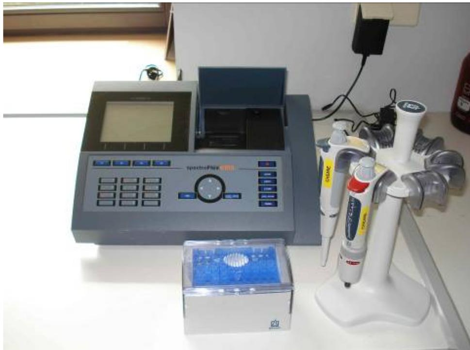
Spectrophotomètre servant à déterminer la concentration en nitrates des échantillons.
