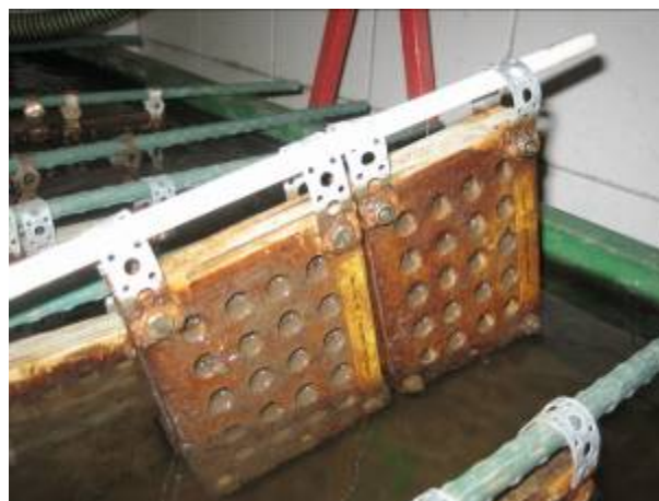
Plaques perforées dans un cours d'eau artificiel au Moulin de Kalborn.
