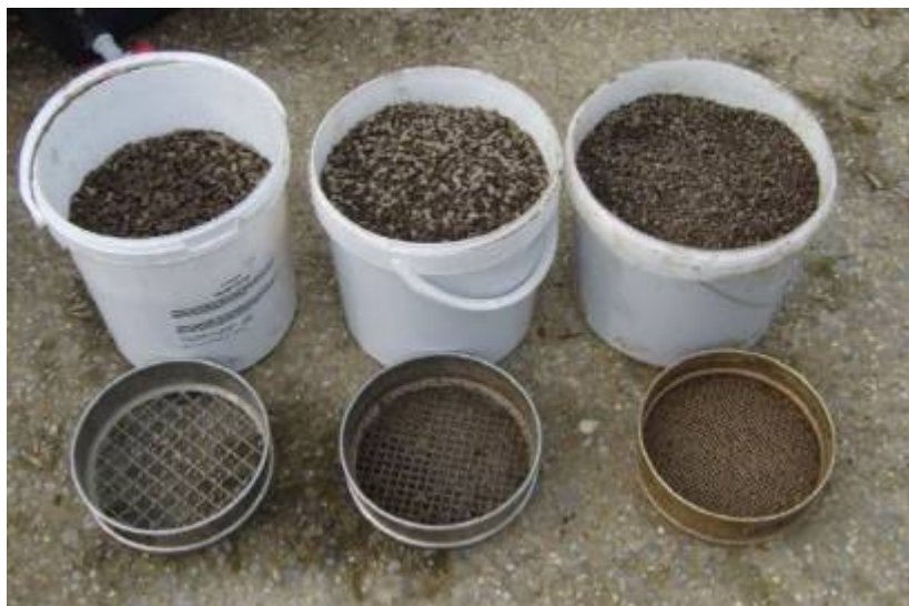
Différentes fractions de gravier: calibre grossier 8/16, moyen 4/8 et fin < 4 \text{mm} .
